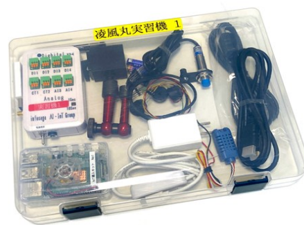
専門員が手作りで作成したIoTキット
