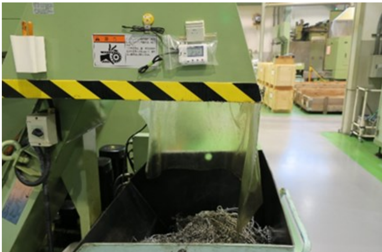
工場内の工作機械に温度センサーを設置し、温度を遠隔で監視できるシステムを導入
